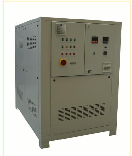
**Mechanischer Aufbau:** Anschlussfertig mit allen erforderlichen Bauteilen auf lackiertem Gestell mit Verkleidungsblechen, Verrohrung und Armaturen aus Stahl bzw. Sphäroguss, Ausdehnungsgefäß (120 l), manuelle Befüllung des Umlaufsystems über separaten Anschluss. Durch Heizungspufferspeicher 200l schnelle Aufheizraten realisierbar.
