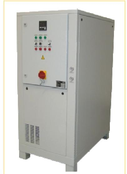
**Mechanischer Aufbau:** Anschlussfertig mit allen erforderlichen Bauteilen auf lackiertem Gestell mit Verkleidungsblechen, Verrohrung und Armaturen aus Stahl bzw. Sphäroguss oder Messing, Ausdehnungsgefäß (35 l), manuelle Befüllung des Umlaufsystems über separaten Anschluss. Optional automatische Befüllung und Entlüftung.
